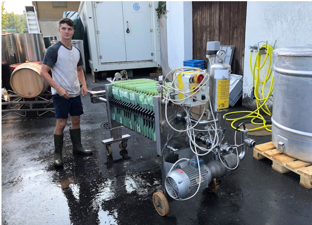
Die Filteranlage muss während der Lesezeit immer wieder gereinigt werden.
